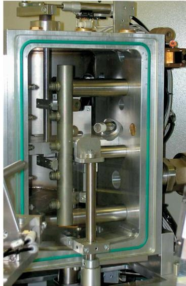
**Bild 2: CRI-Rail eingelegt in der Testkammer einer TLF-Dichtheitsprüfanlage.**
