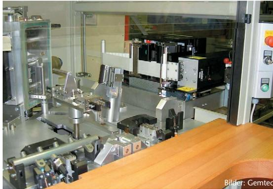
**Bild 3:** Handlingsystem einer TLF-Dichtheitsprüfanlage.
