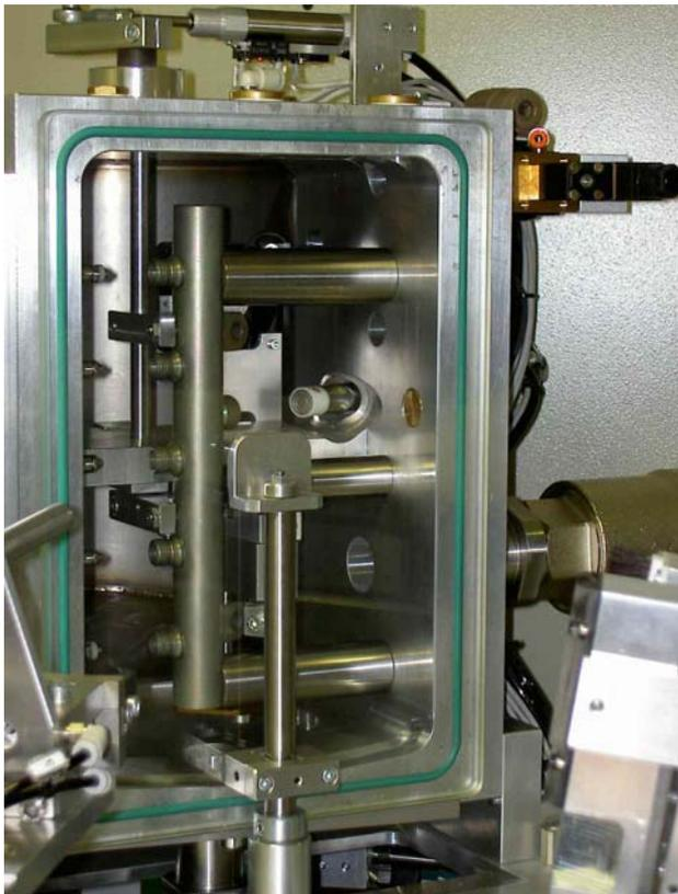
Bild 24: Anwendungsbeispiel integrale Dichtheitsprüfung im Vakuum
