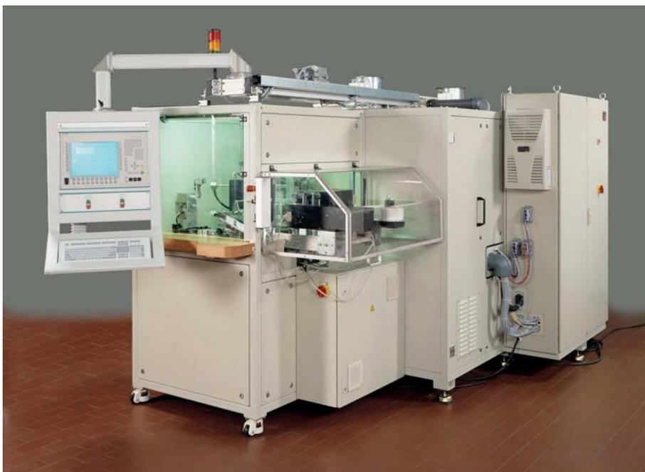
Bild 23: Anwendungsbeispiel integrale Dichtheitsprüfung im Vakuum
