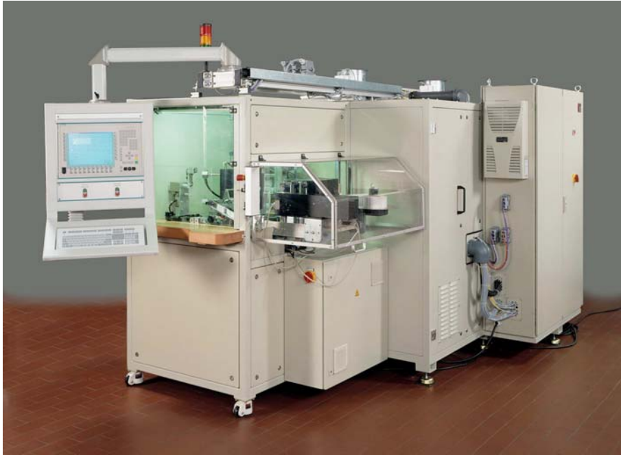
Bild 14: Anwendungsbeispiel integrale Dichtheitsprüfung im Vakuum Gesamtansicht TLF-Dichtheitsprüfanlage
