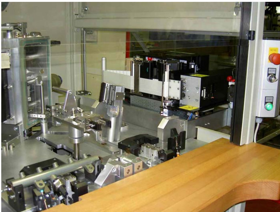
Bild 17: Anwendungsbeispiel integrale Dichtheitsprüfung im Vakuum Prüfmodul mit integriertem Handlingsystem einer TLF-Dichtheitsprüfanlage
